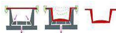
Figura No. 23 Proceso Termoformado
