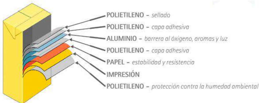
Figura No. 48 Materiales del Tetra Pak® y sus propiedades 50
