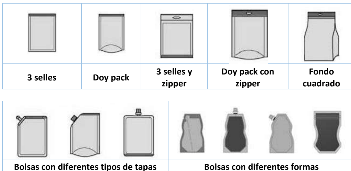
Figura No. 31 Formas de bolsas flexibles
